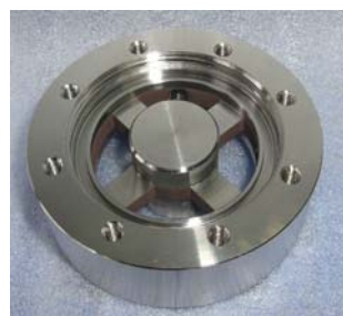
【写真】 SUS630 弊社真空炉にて H900処理後
